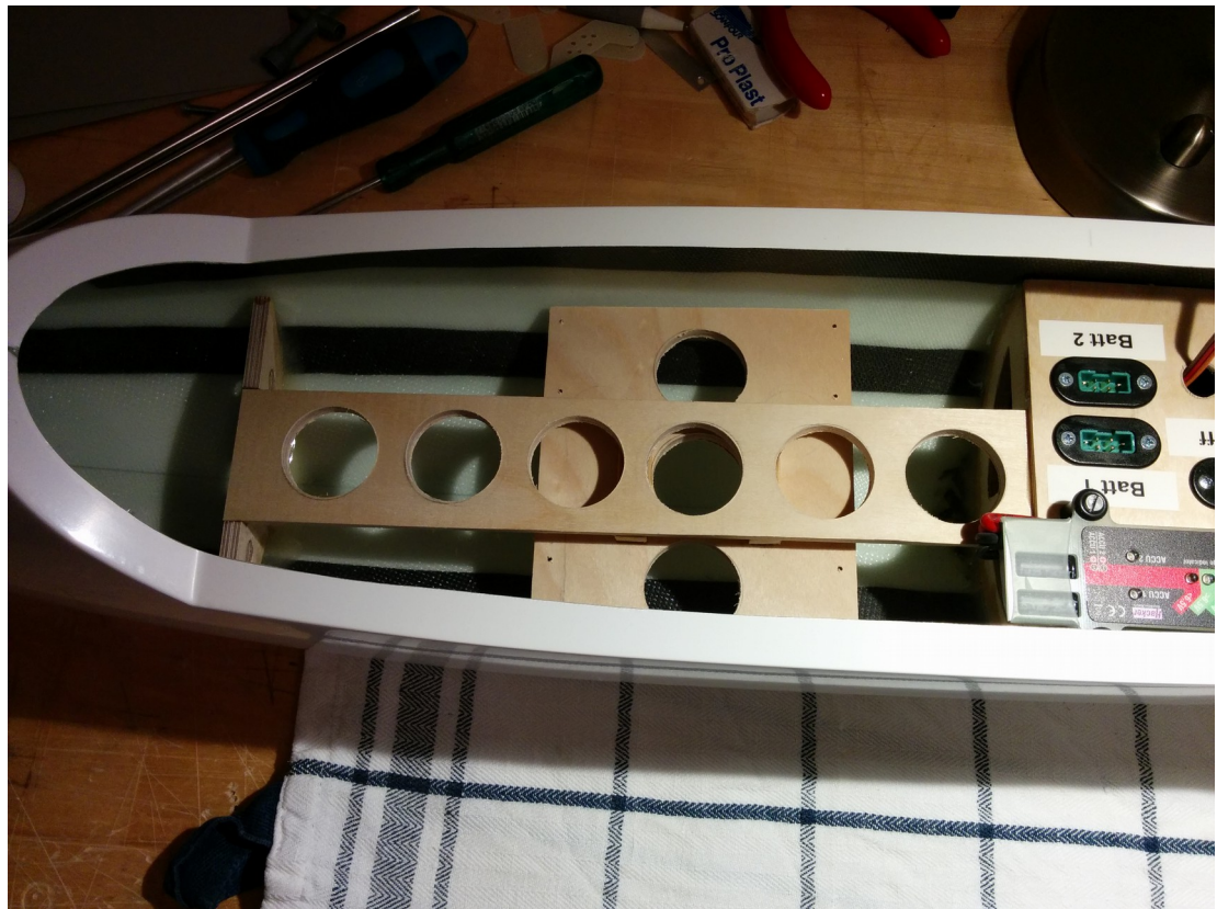
Ovan ser man fästplattorna för batterier mm på plats.
