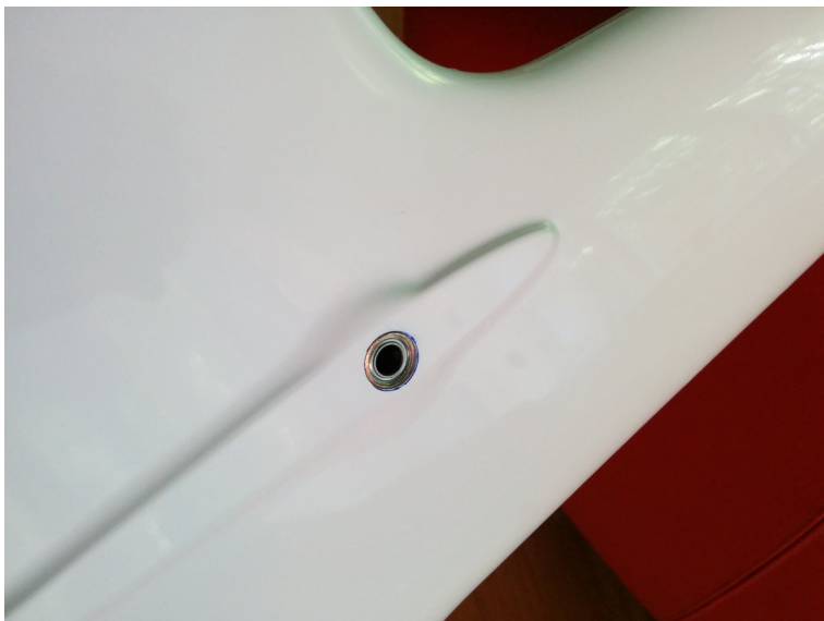
Mässingsrör med kullager genom fenan
